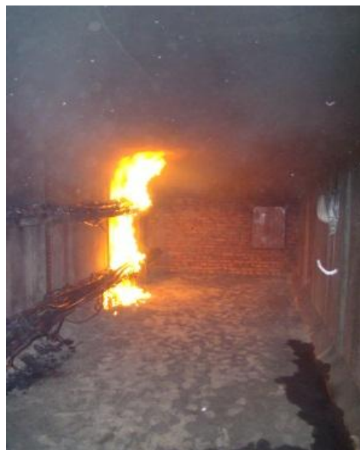
Рисунок 5.52 – Фрагменты свободного горения кабельной продукции
