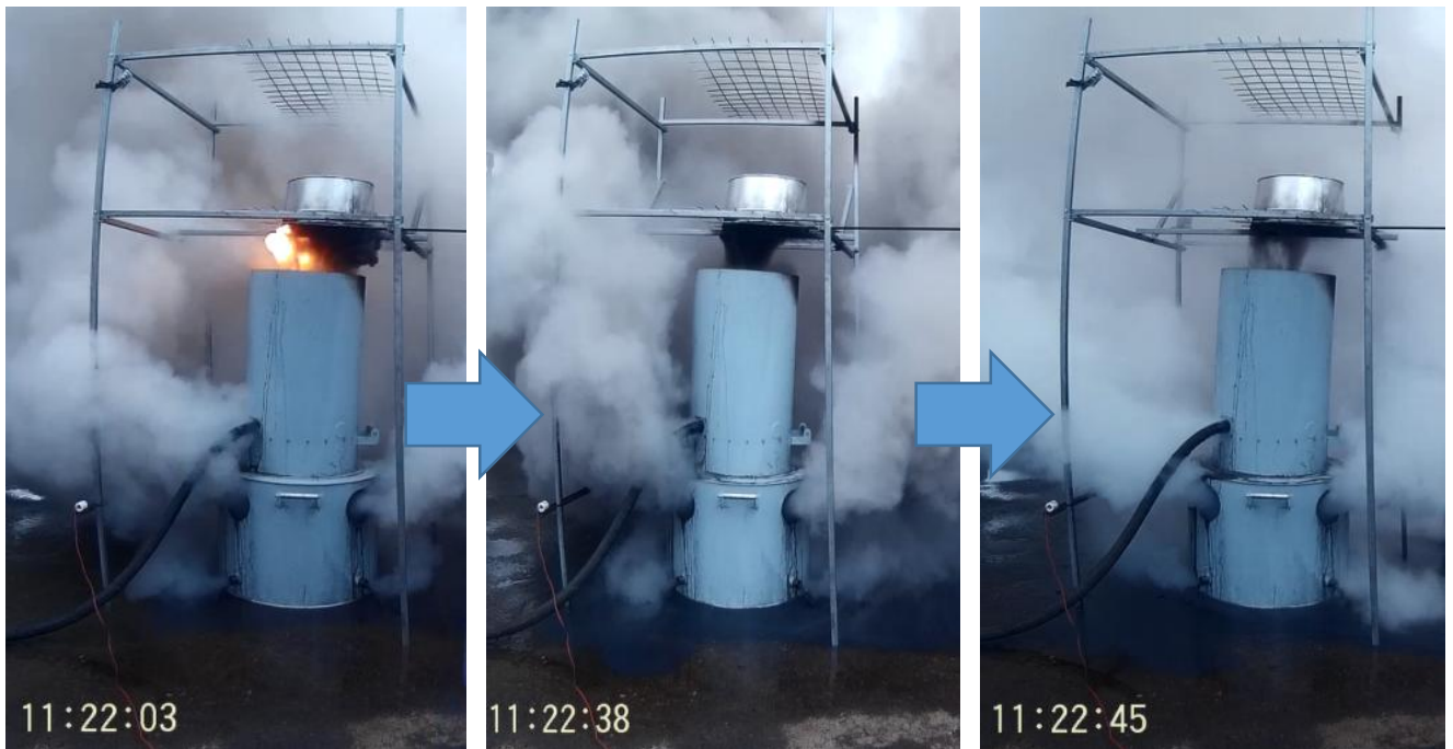
Рисунок 5.25 – Осаждение дымовых частиц ( P = 2 МПа, T = 180 °С)
