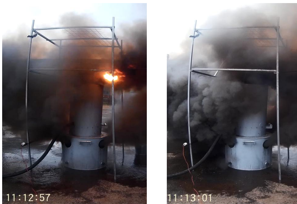
Рисунок 5.22 – Осаждение дымовых частиц ( P = 2 МПа, T = 20 °С)
