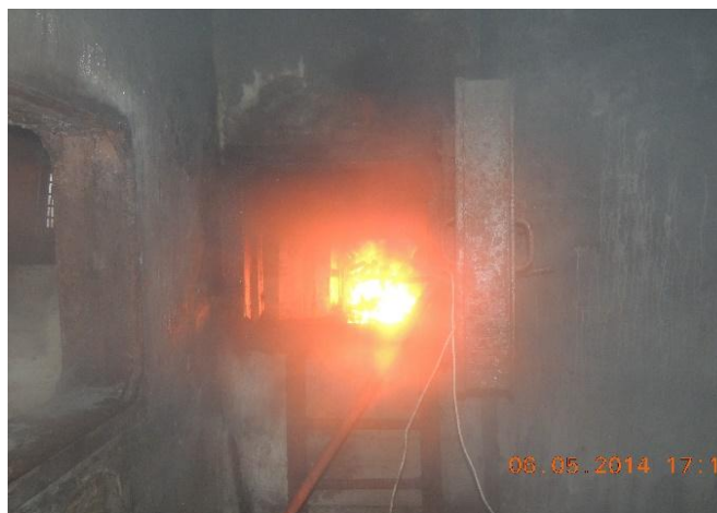
Рисунок 5.34 – Модельные очаги кабельной продукции и горючих жидкостей
