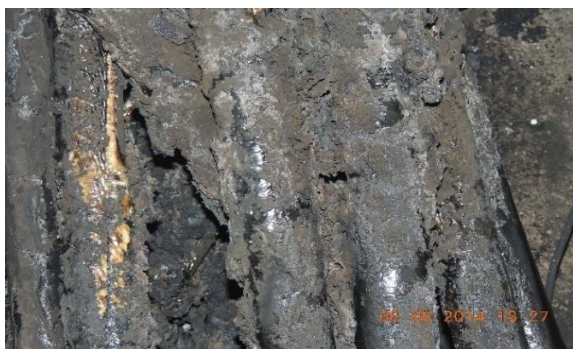
Рисунок 5.39 – Общий вид кабельной продукции после проведения эксперимента по прекращению открытого горения посредством технологии ВСМФС
