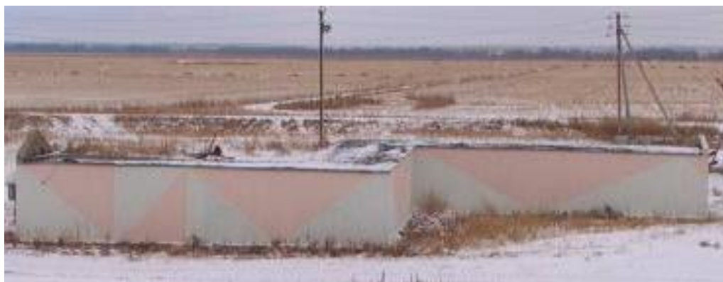
Рисунок 5.49 – Общий вид макета кабельного коллектора зигзагообразной формы
