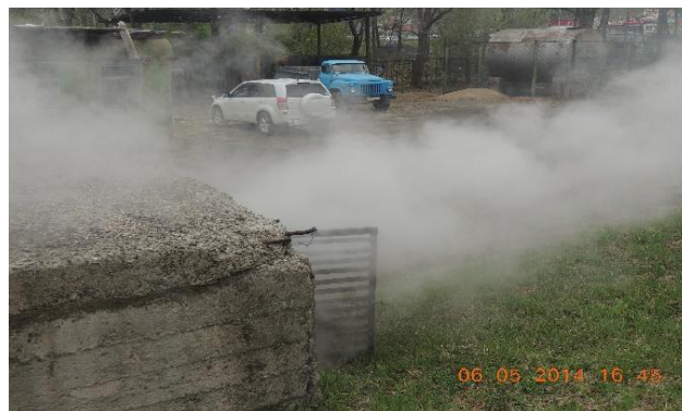
Рисунок 5.38 – Выход среды ВСМФС из вентиляционной шахты после прекращения горения кабельной продукции
