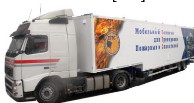
Мобильная теплодымокамера ПТС «Грот» [249]
