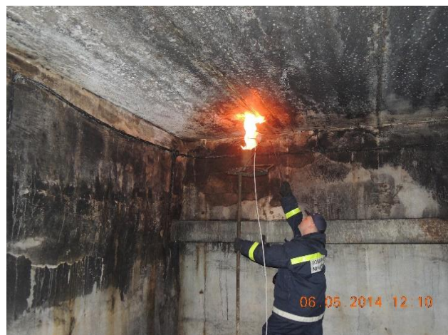
Рисунок 5.34 – Модельные очаги кабельной продукции и горючих жидкостей
