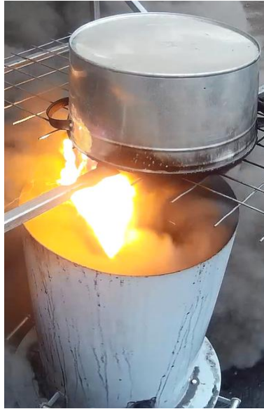
Рисунок 5.20 – Работа экспериментального устройства осаждения дыма ( P = 2 МПа, T = 20 °С)
