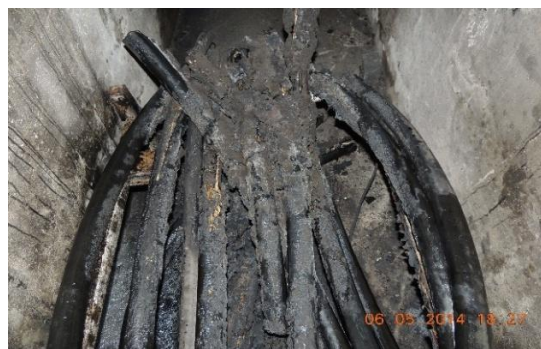
Рисунок 5.39 – Общий вид кабельной продукции после проведения эксперимента по прекращению открытого горения посредством технологии ВСМФС
