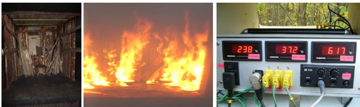
Рисунок 4.22 – Горючая нагрузка, ее горение и контроль воздействия температуры при проведении тренировки на огневом тренажере
